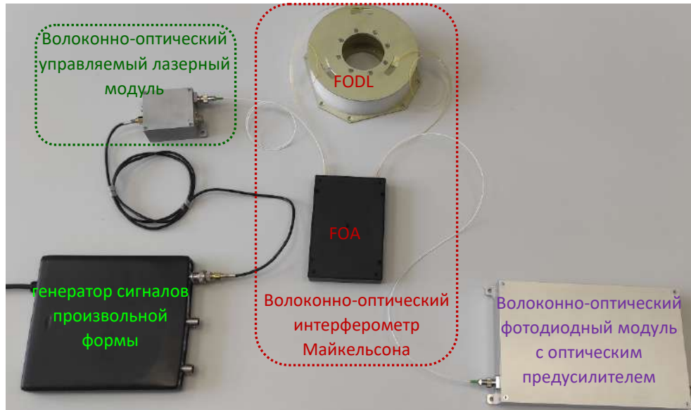
Рис. 2. Радиофотонное устройство для генерации сверхширокополосных СВЧ-сигналов на основе самогетеродинирования излучения лазерного диода с помощью волоконно-оптического интерферометра Майкельсона с зеркалами Фарадея:
